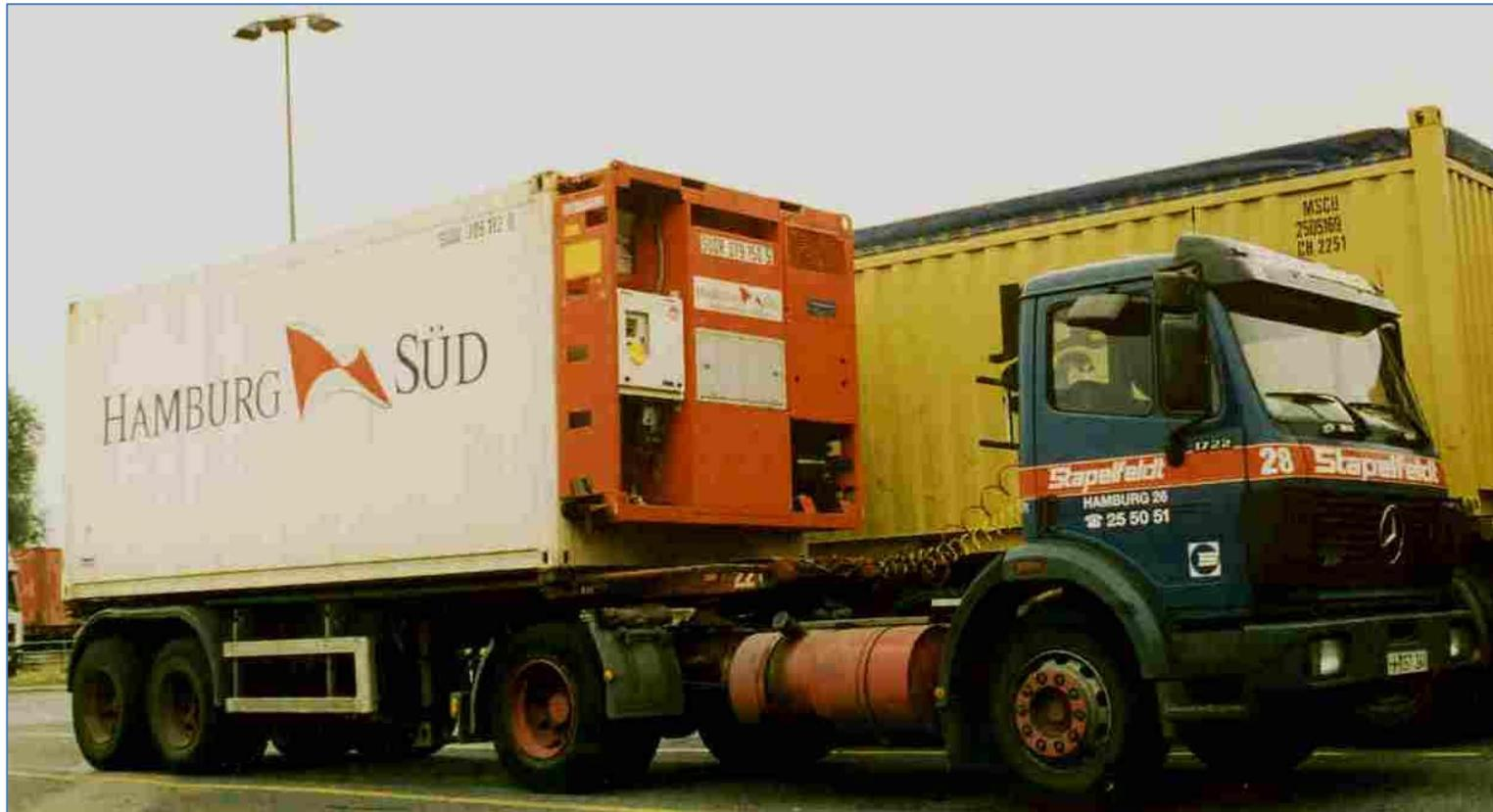
Porthole-Container mit Clip-On-Unit auf einem Lkw, Quelle: Ursula Horn
