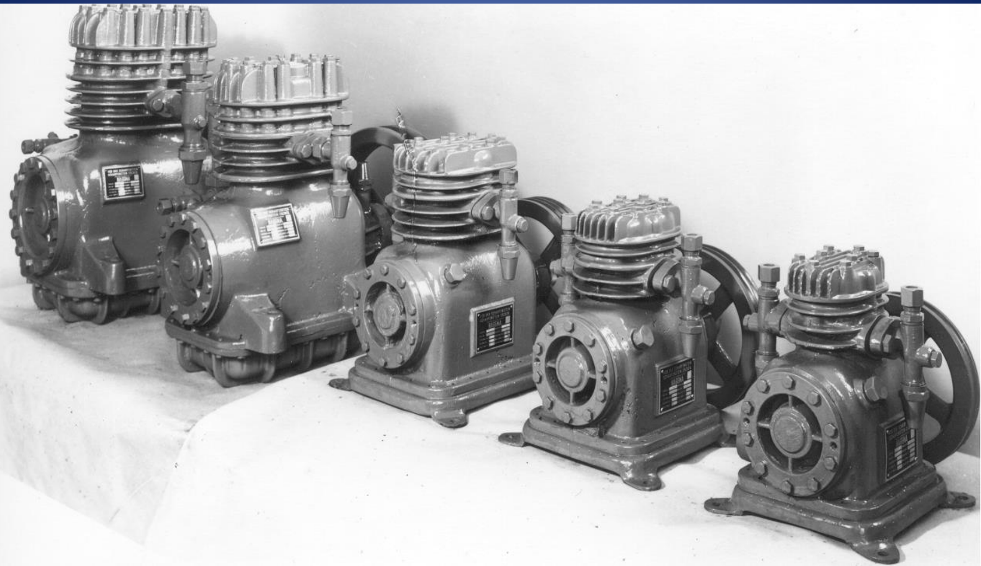
DKK HubkolbenKompressoren K 352 bis K 1202 von 1939
