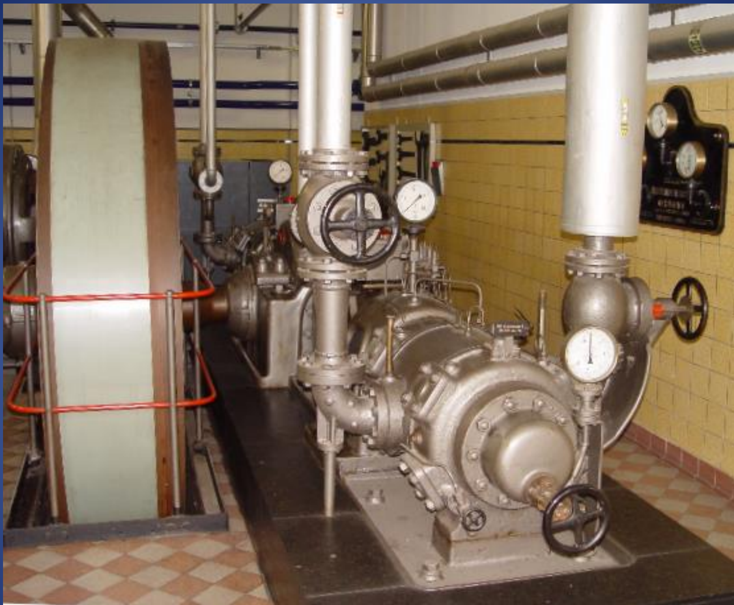
Verdichter System Linde, Hersteller Maschinenfabrik Esslingen, Type 2/40L400, Baujahr 1939
