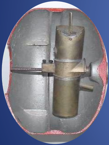
Verdampfer mit Ölrückführung
