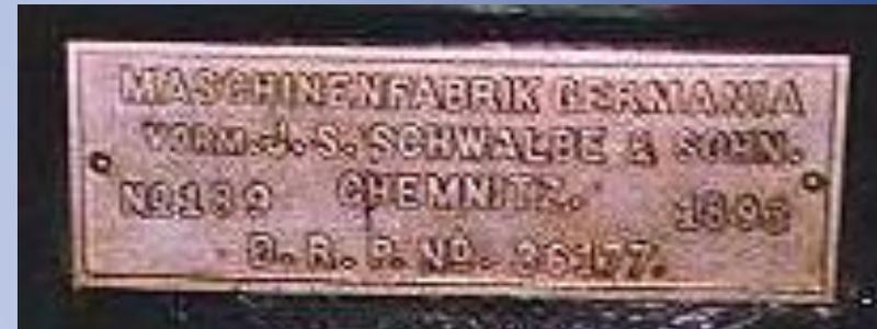
Zwillingsverdichter der Maschinenfabrik Germania, Nr. 189, Baujahr 1893 - Antrieb durch eine Kolben-Dampfmaschine.
