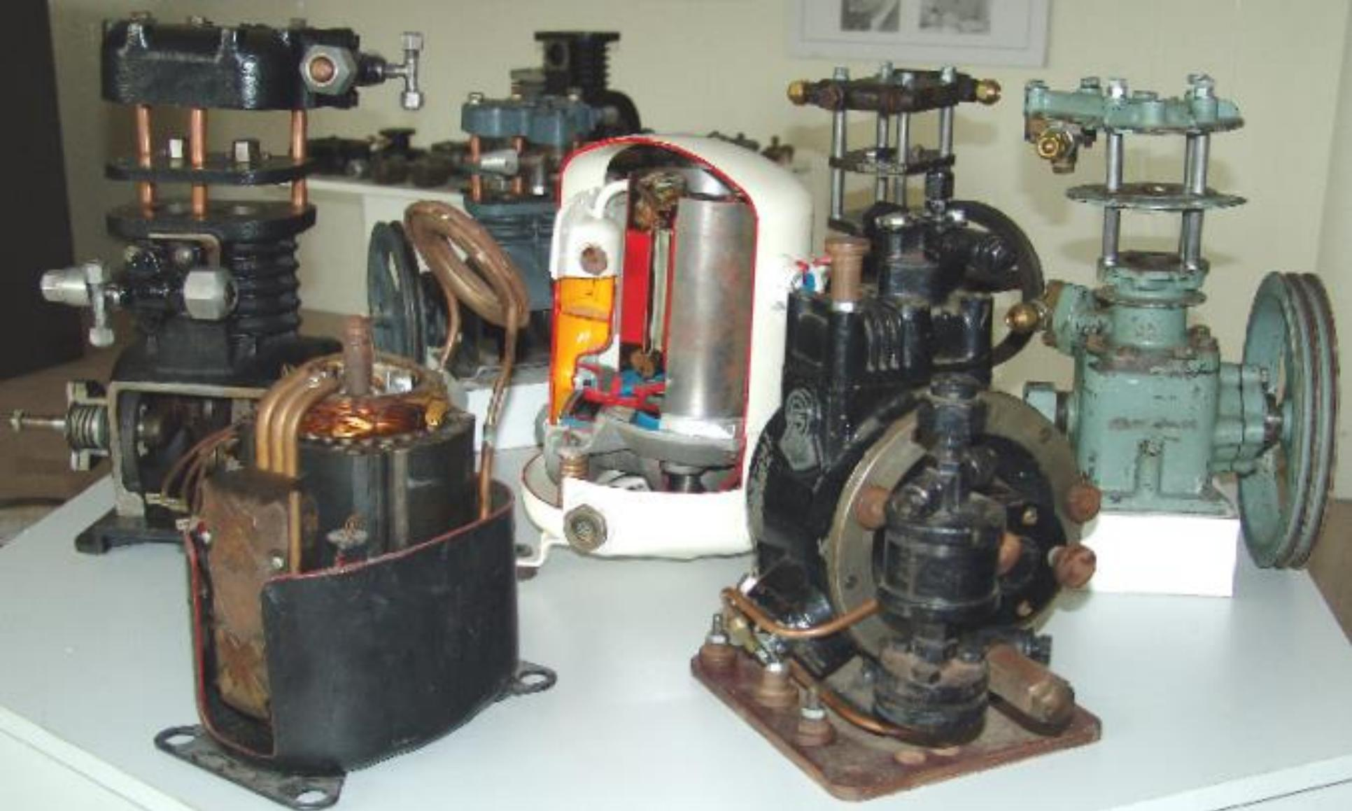
diverse Verdichter vom Gleichstrom-Hubkolben bis hin zum Rollkolbenverdichter für gewerbliche Anlagen
