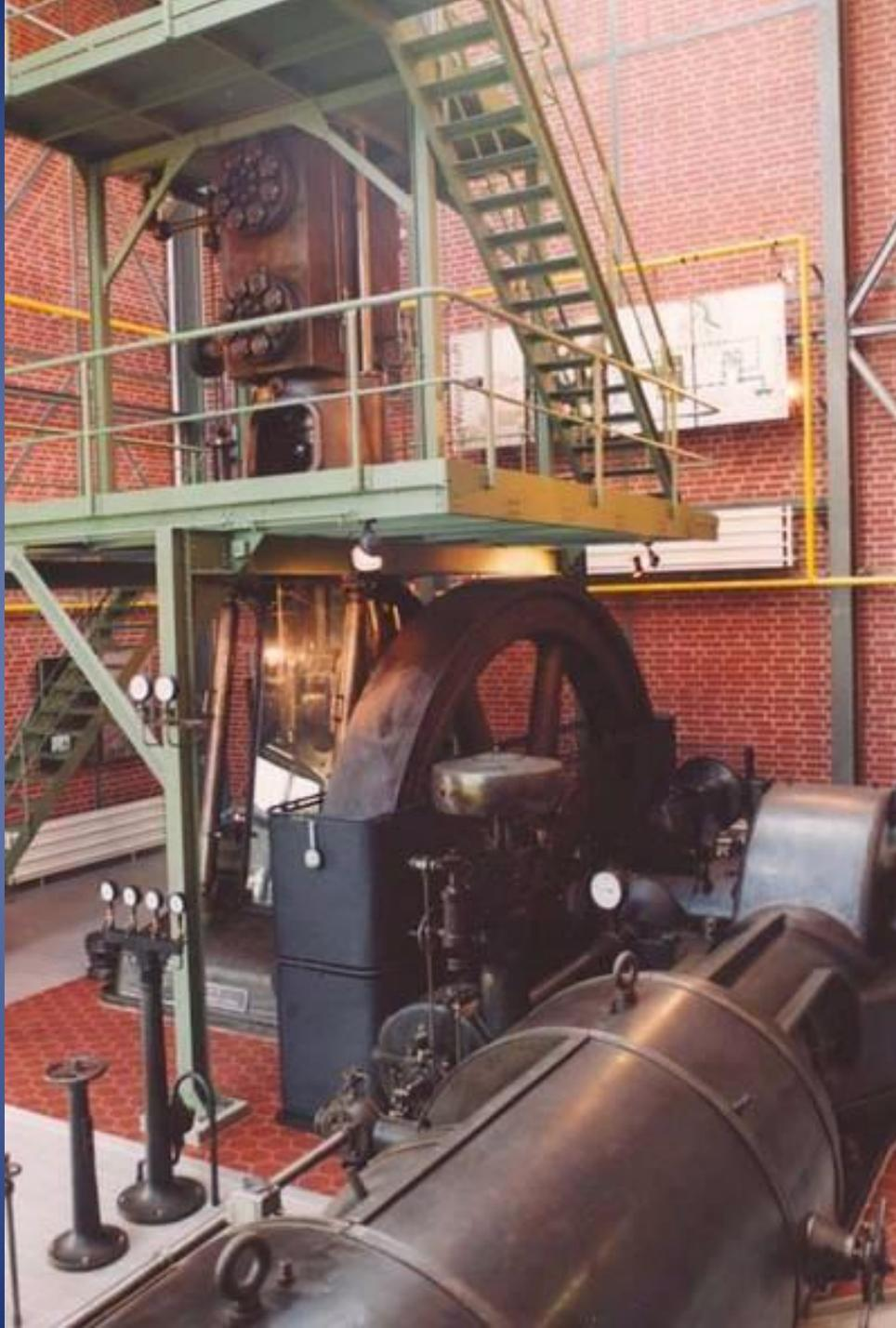
Kreislaufkompressor der Ammoniaksynthese, Antrieb durch eine 650 PS Gleichstromdampfmaschine. Der einstufige stehende Kolbenverdichter wurde 1925 von der Maschinenfabrik Esslingen hergestellt - er hat eine Höhe von 8,5 m und eine Förderkapazität von 100.000 m<sup>3</sup>/h.
