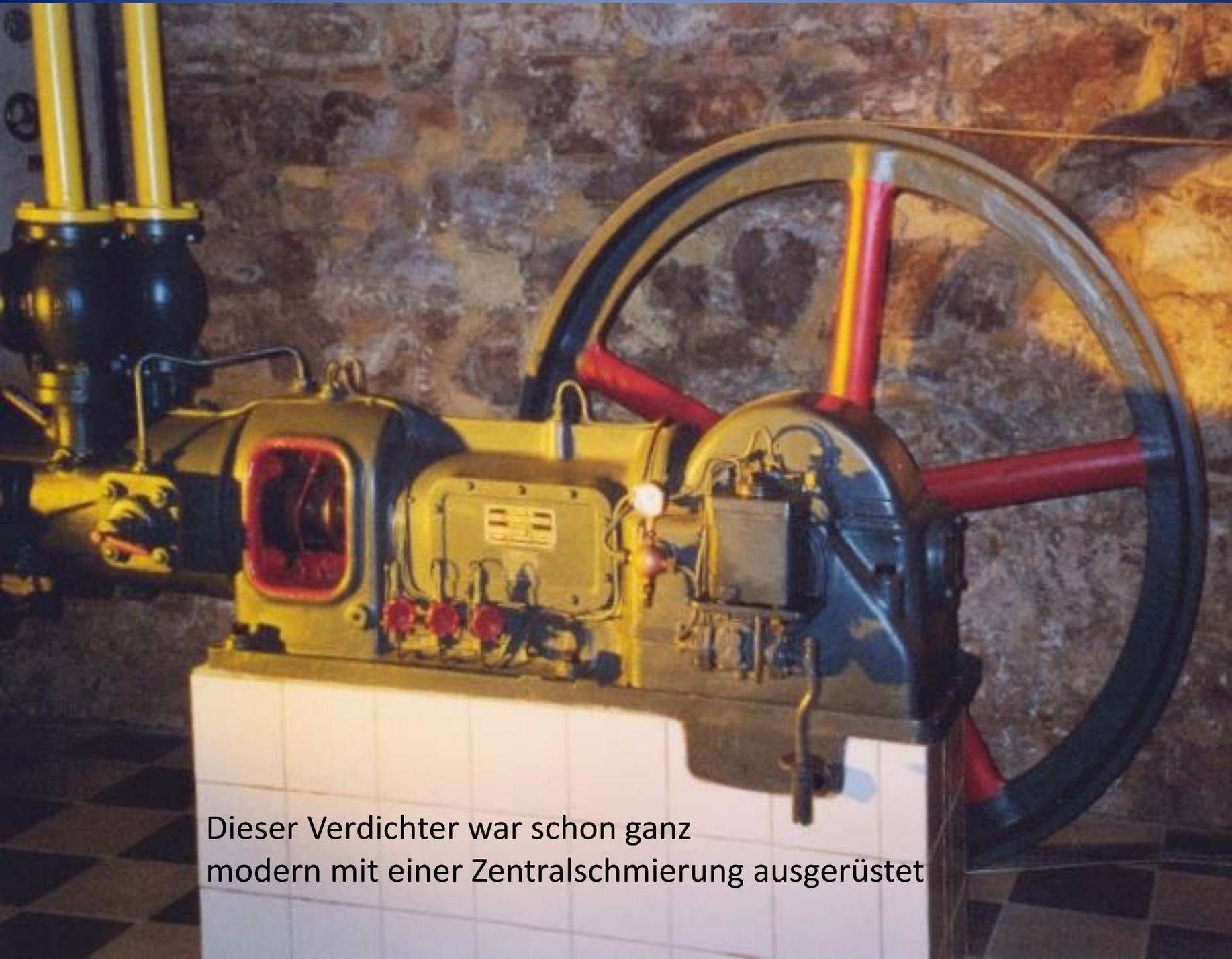
Dieser Verdichter war schon ganz modern mit einer Zentralschmierung ausgerüstet
