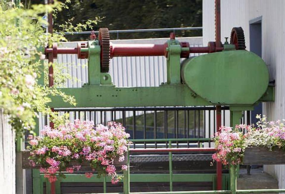
Das Wehr am Auer Mühlbach mit der Jonval-Wasserturbine, gebaut von der Firma MAN Baujahr 1880, sind noch immer funktionsfähig und können zur Demonstration in Betrieb genommen werden.
