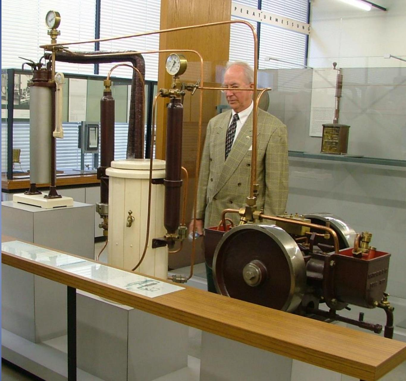
Carl von Lindes erste Luftverflüssigungsanlage von 1905
