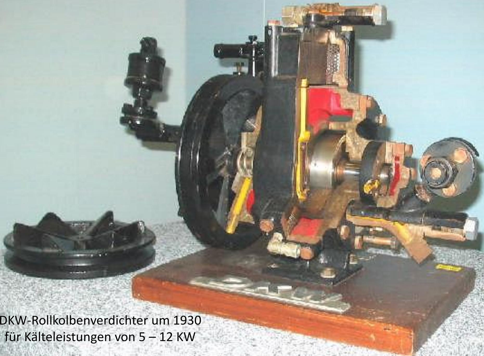
DKW-Rollkolbenverdichter um 1930
