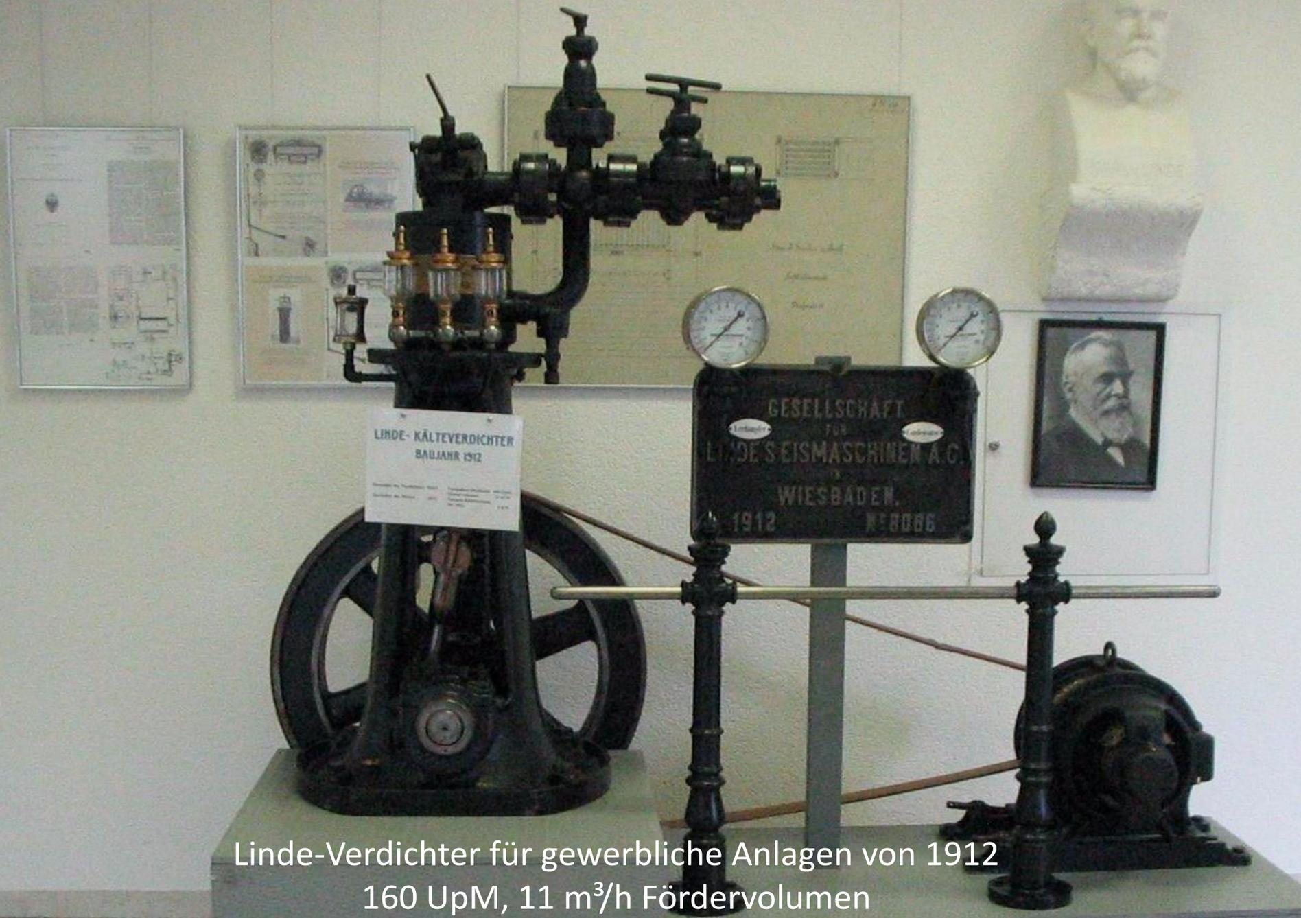
LINDE - KÄLTERDICHTER
