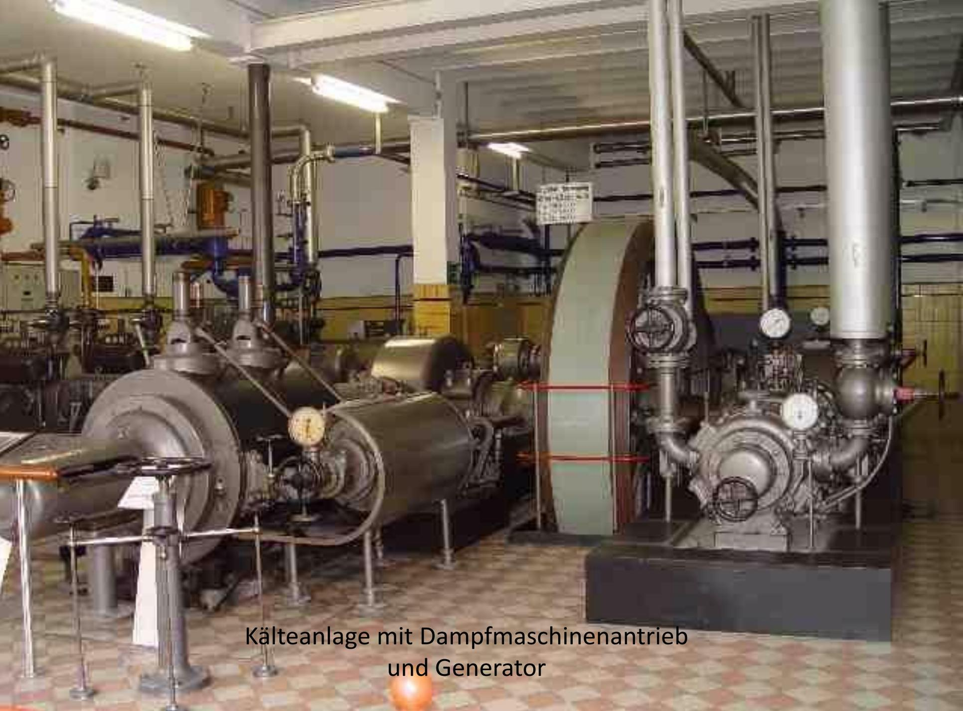
Kälteanlage mit Dampfmaschinenantrieb
