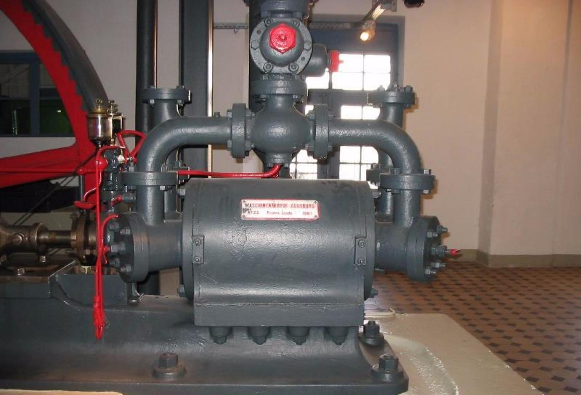
Zylinder- Durchmesser 325 mm; Hub 540 mm; Drehzahl 60 UpM
