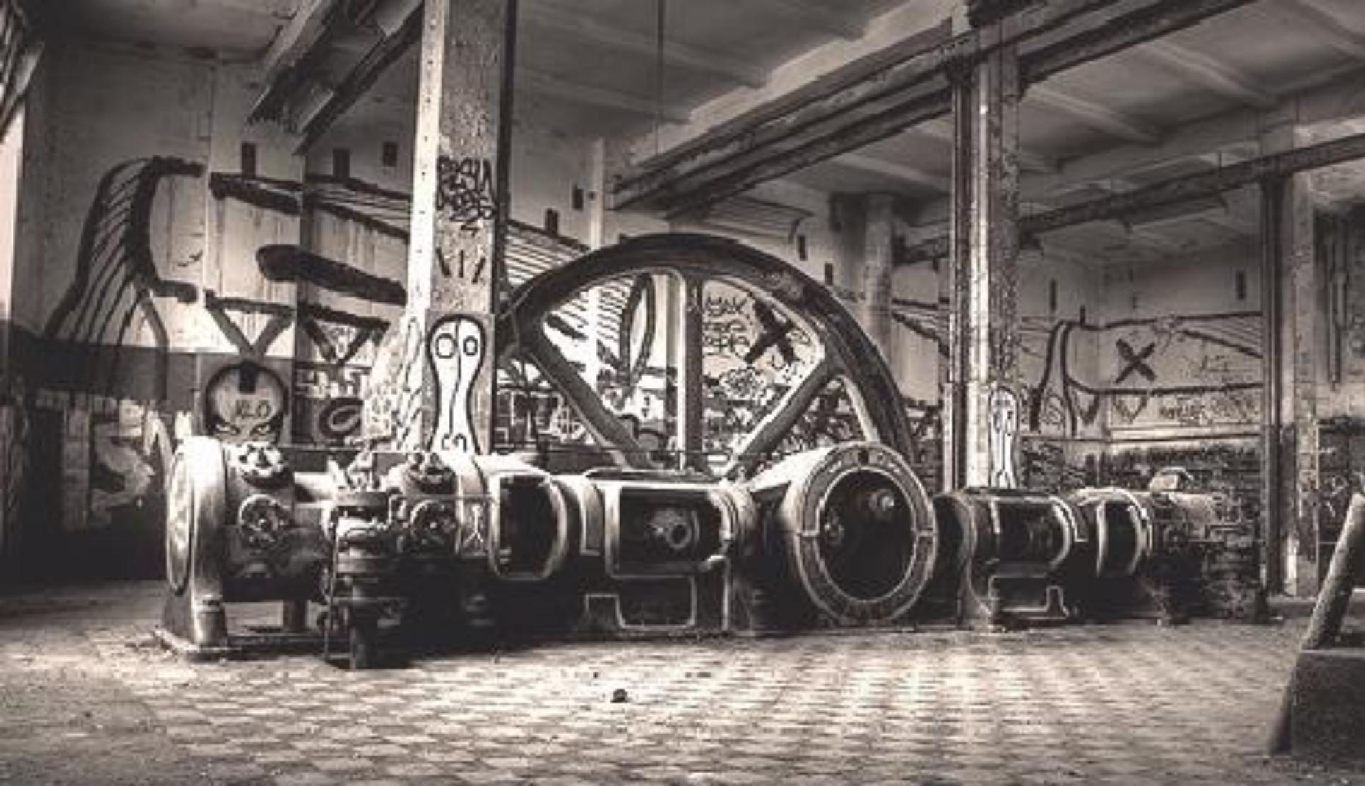
in dem Maschinenraum befindet sich ein großer Tandemverdichter von 1914 nach verschiedenen Veröffentlichungen angeblich von Linde
