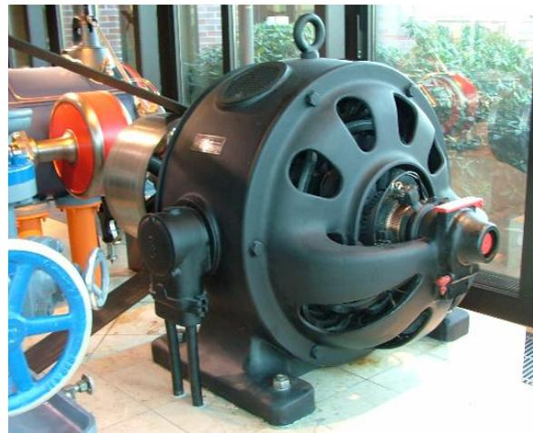
Antrieb durch eine Einzylinder-Dampfmaschine mit Lenzsteuerung, Nr. 4838 der MAN AG und einem Generator zur Stromerzeugung von Siemens-Schuckert, Type IF2819/750. - Die Anlage repräsentiert den damaligen Standard in Brauereien – sie waren damit unabhängig vom Natureis und hatten eine sichere Stromversorgung für Beleuchtung und Nebenaggregate wie Pumpen und Rührwerke. - Die Anlage war bis 1982 im Betrieb.
