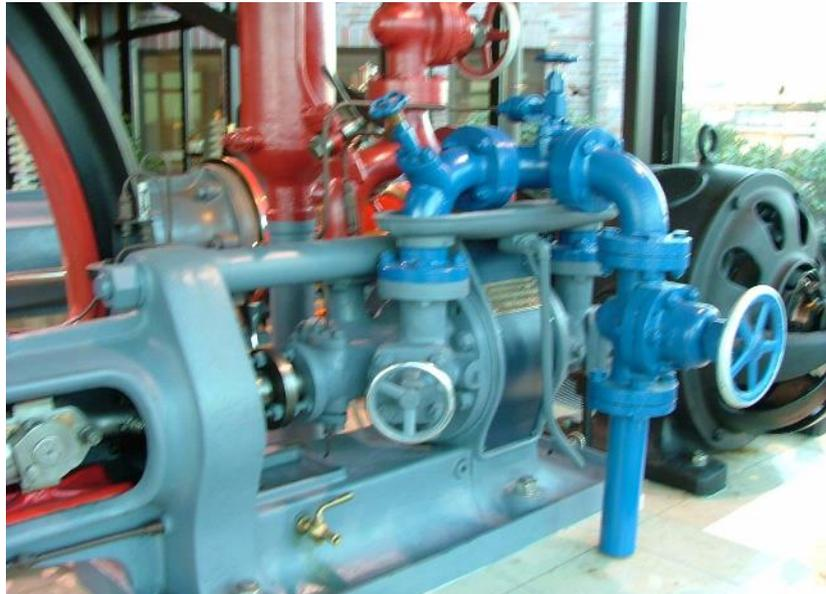
des Unternehmens als Zeugnis der industriellen Entwicklung sehr dekorativ aufgestellt. Das Assembler besteht aus 2 einstufigen Kreuzkopfverdichtern, System Linde Type 9 Nr. 2727 und 3269, Baujahr 1914, Hersteller MAN AG Augsburg -
