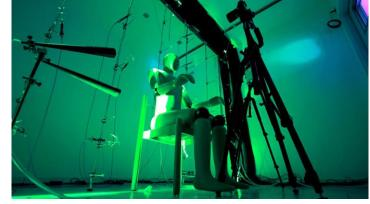
ansteuerbar und können von etwa +10 bis +40 °C temperiert werden. Dadurch sind verschiedenste Szenarien, von der kalten ungedämmten Wand bis zur warmen Wandheizung möglich. Als »Proband« dient das menschenähnliche Manikin »Feelix«. Dieses hat Heizdrähte und Sensoren unter seiner aus Glasfaser bestehenden Oberfläche sowie eine Pumpe, wodurch Körperwärme und Atmung simuliert werden. Damit wird der wechselseitige Einfluss von Mensch und Raumklima untersucht.
