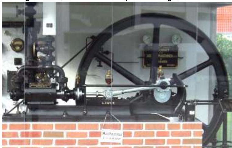
Bild: HKK –Kreuzkopfverdichter
