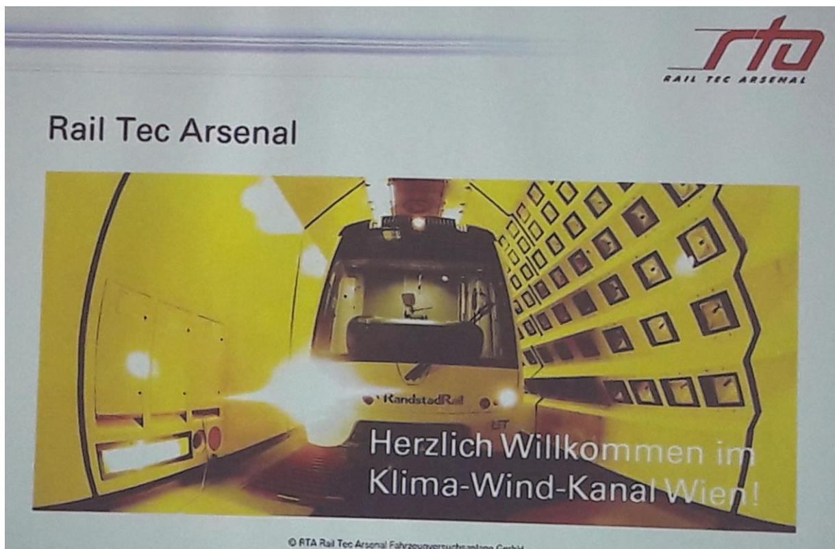
**Das Rail Tec Arsenal, der weltweit größte Klima-Windkanal zur Prüfung von Fahrzeugen aller Art bei Temperaturen von – 45 bis +60 °C, Windgeschwindigkeit bis 300 km/h, Luftfeuchten von 10 bis 98%, so wie Schnee und Regesimulation.**
