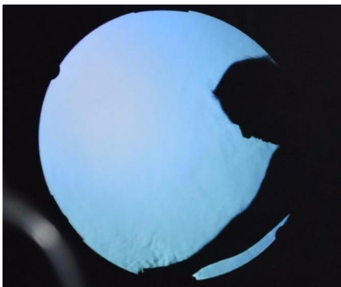
Sehr innovativ ist auch der Schlierenspiegel im Strömungslabor, mit dem geringste Strömungen völlig ohne Beeinflussung durch Messgeräte beobachtet werden können – Testproband Dr. Lange!
