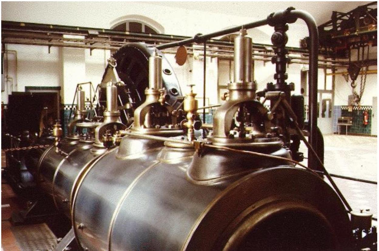
Die Sulzer-Dampfmaschine war bis 1972 für Strom- und Kälteversorgung zuständig. Sie trieb aber auch alle Pumpen und Rührwerke über Transmissionsriemen an.
