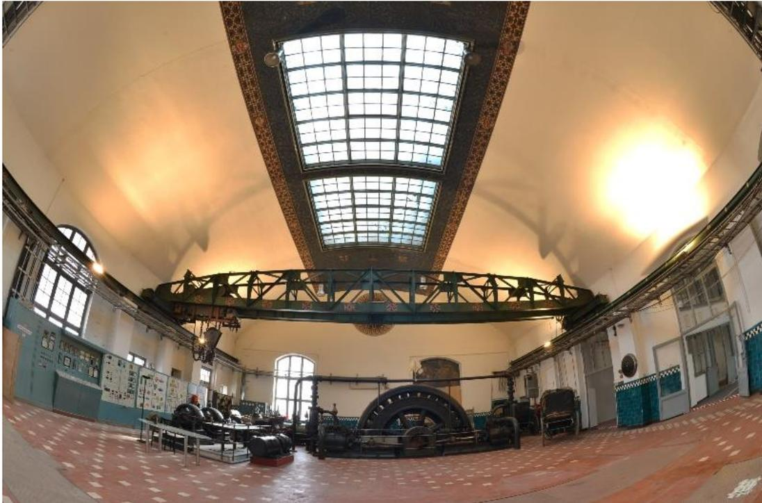
Als Ergebnis entstand ein phantastisches Industriedenkmal in einem sehr ansprechenden Umfeld. Die historische Technik im Maschinenhaus besteht aus Laufkatzenanlage, Dampfmaschine, Stromgenerator und zwei Kreuzkopf-Kälteverdichtern nebst Schaltanlage und Pumpen von 1893 – ein Highlight für Technik- und Historikbegeisterte! Sehen Sie dazu ein Video der Anlage von 1972 – [Dampfmaschine in Funktion!](#) ( erst speichern, dann öffnen)
