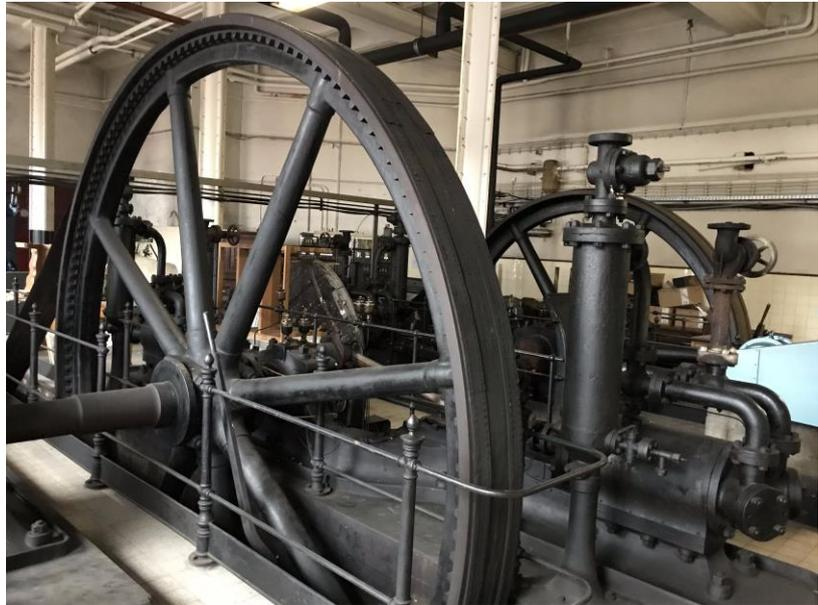
Die im Maschinenhaus befindlichen Verdichter sind interessant, aber so nicht vorzeigbar: 2 Linde Tandemverdichter von 1899, ehemals angetrieben durch eine Dampfmaschine, später über Flachriemen durch einen 450 PS Elektromotor, installiert im Keller. Daneben befinden sich noch weitere Verdichter aus den 50er Jahren von Stein, Linde und Astra.
