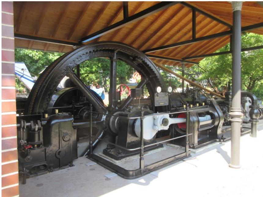
Unterstützt wird das Museum durch den **Förderverein Dampfmaschinenmuseum e.V.** Dieser Verein hat im Freigelände neben dem Museum (**Bild**) eine interessante Maschinenkombination - einen direktgekoppelten Linde Verdichter Nr. 2355 Baujahr 1911, mit einer MAN Tandem-Dampfmaschine mit Lentz Ventilsteuerung, originalgetreu überarbeitet.
