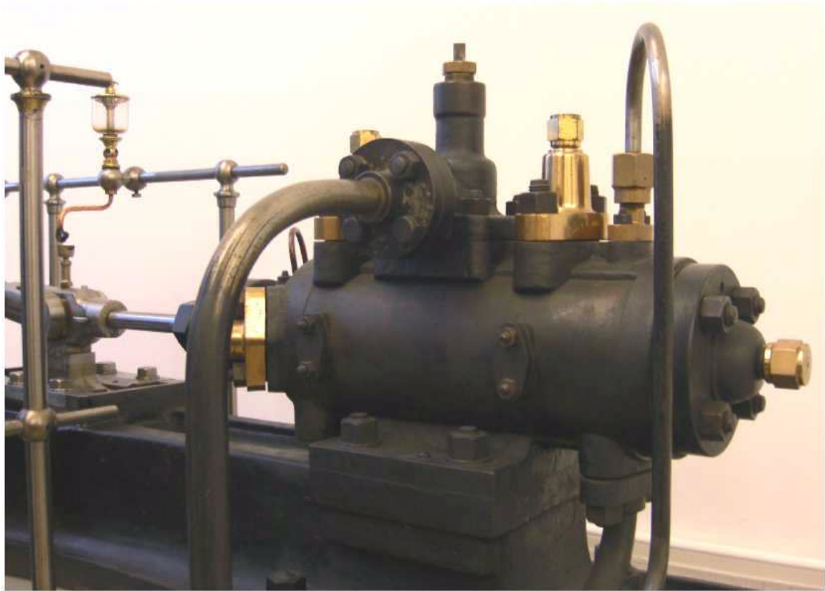
Der Verdichter - die Dimensionierung von Saug- und Druckleitung und die Ausführung der Ventile in Messing lassen auf einen Kohlensäure-Kompressor schließen - eine interessante Anwendung mit R 744 - der Verdichter war vermutlich von 1908 bis 1977 über 250 000 h in Betrieb.
