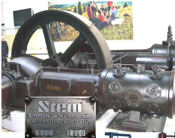
Im Maschinenraum der Brauerei befindet sich ein gewaltiger liegender, doppelwirkender Kältemittelverdichter Fabrikat STEIN von Assmann & Stockder, Stuttgart-Münster, Baujahr 1940. Der Antrieb erfolgte durch eine Dampfmaschine von Buckau R.Wolf AG, Magdeburg, Baujahr 1939.
