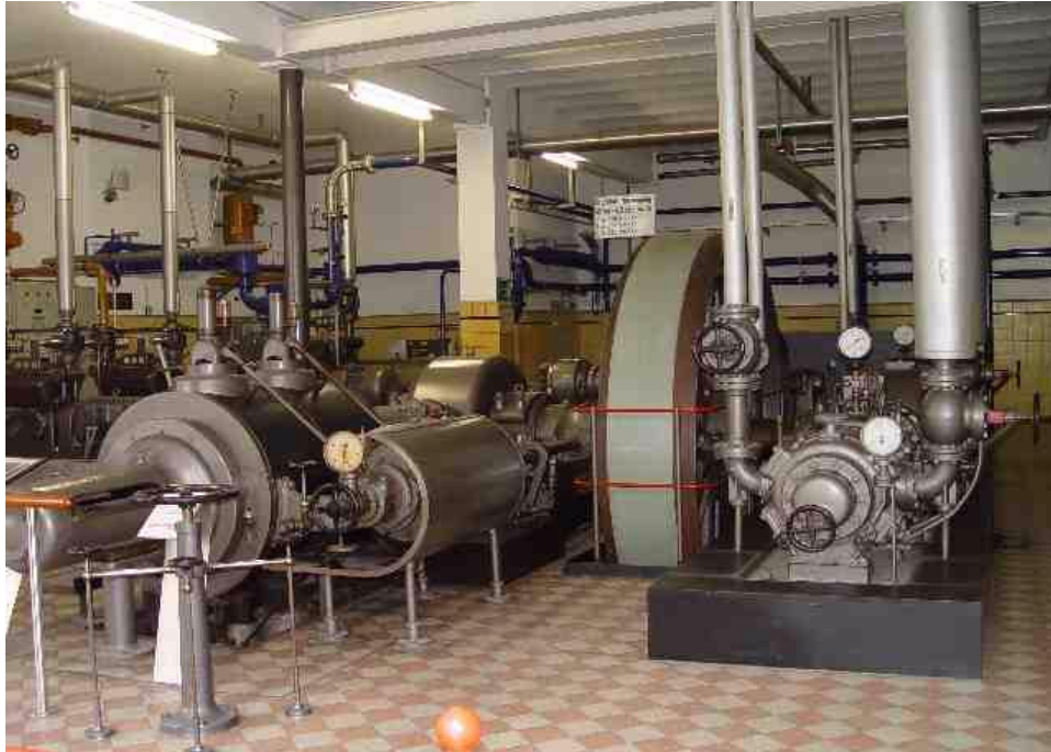
Verdichter System Linde, Hersteller Maschinenfabrik Esslingen, Type 2/40L400, Baujahr 1939, Verdichter, 1-stufig, doppelwirkend, Kältemittel NH 3
