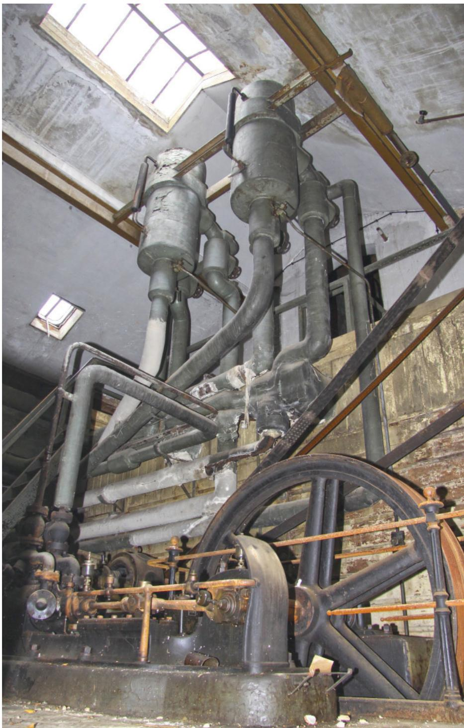
Der erste Verdichter der Maschinenfabrik Germania stammt aus dem Baujahr des Schlachthofes, 1899.
