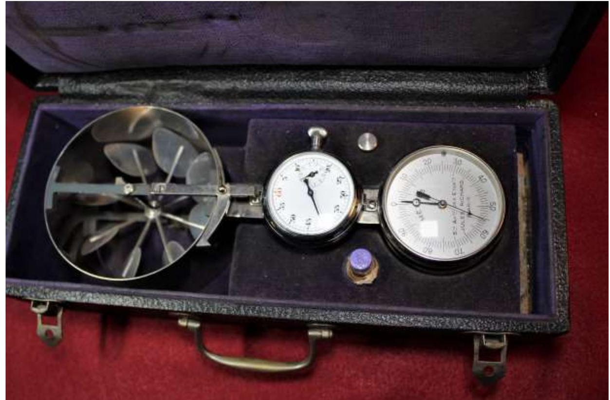
Ein *Flügelrad-Anemometer* ist im Prinzip eine kleine, nahezu freilaufende Windkraftanlage. Die zu messende Geschwindigkeit der Strömung wird bei diesen Geräten mechanisch auf eine Anzeige übertragen, die für die zur Winkelgeschwindigkeit des Flügelrades passende Angabe skaliert ist, und umgerechnet in Meter pro Sekunde.
