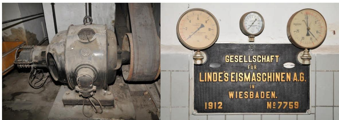
An bei Fotos der historischen Linde- Maschine. Der Gleichstrommotor Siemens-Schuckert sitzt ein Stockwerk tiefer. Das Schutzgeländer ist original und vollständig vorhanden. Der Motor lässt sich über einen Schacht nach oben bergen. Die Maschine ist ebenerdig aufgestellt. Sollten die Tore nicht groß genug sein, so ist es möglich ein Stück Mauer herauszubrechen. Die original Mehrstufenschalter sind auch vorhanden.
